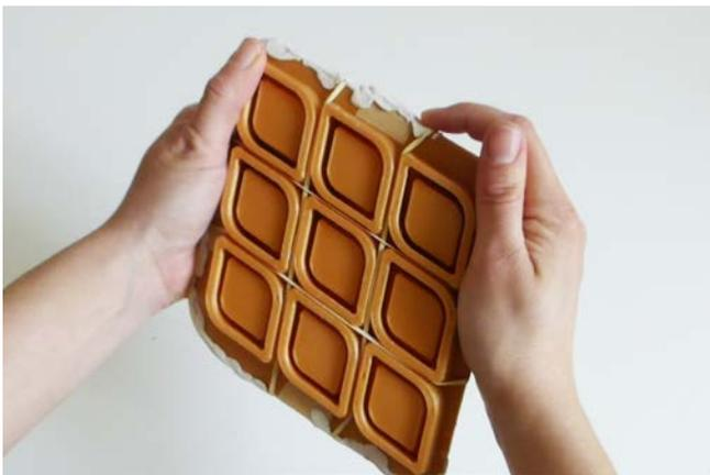
3. Assemblage des deux parties à l'aide d'élastiques puis renforcement des bords avec de de la plastiline, afin de rendre le coffrage étanche
