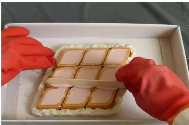
5. Enlèvement de l'excédant de silicone à l'aide d'une baguette, puis faire disparaître les bulles emprisonnées dans le silicone en utilisant un plateau vibrant
